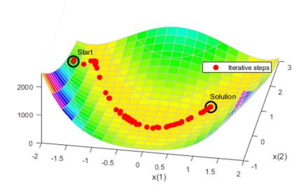
通过输出参数 output.funcCount 我们知道 fminsearch 估算了210次目标函数最小值;通过 output.iterations 我们知道 fminsearch 迭代了 114次。
