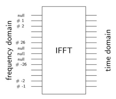
频域数据经过IFFT计算后转化到时域。在IEEE802.11a中,PPDU传输的时间–频域分布图,如下图所示。
